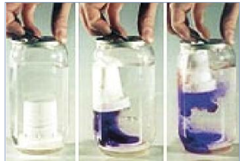
Figura 8. Sistema de liberación de un colorante durante la apertura del envase.
