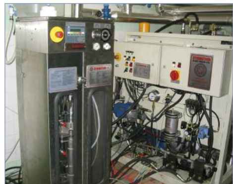
Figura 3A. Nuevo equipo UHPH 400 MPa 125 l/h. CERPTA-UAB (Pat. n.º 10380094.2-1221).
