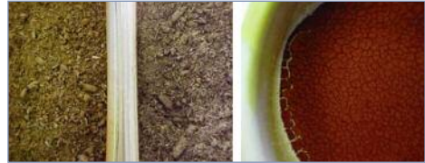
Figura 2. Extracción del pigmento de la caléndula. De izquierda a derecha, harina de caléndula previo y posterior al tratamiento con \text{SCCO}_2 y pigmento extraído. Imagen cedida por Matgas 2000 IAE.
